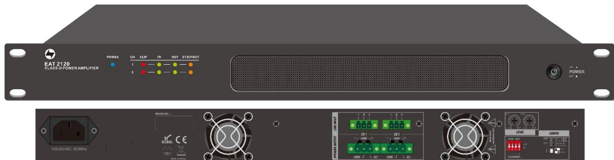
Цифровой усилитель мощности класса D Exell **EAT2120** оснащен технологией импульсного питания, которая обеспечивает минимальное энергопотребление и значительно более высокий КПД - до 85%. Выполненный в дизайне 1U, усилитель позволяет экономить место в монтажной стойке и выделять меньше тепла.
