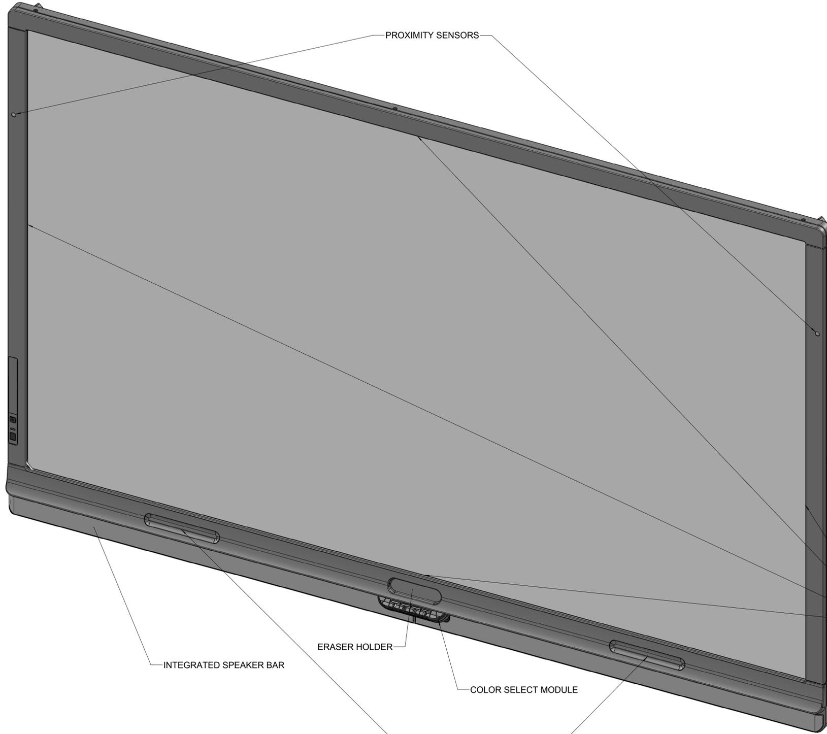
THE WHITE REFLECTIVE SURFACES AROUND THE PERIMETER OF THE SCREEN ARE USED BY THE VISION SYSTEM. DO NOT COVER OR BLOCK THESE SURFACES.
