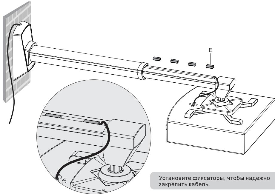
Установите фиксаторы, чтобы надежно закрепить кабель.
