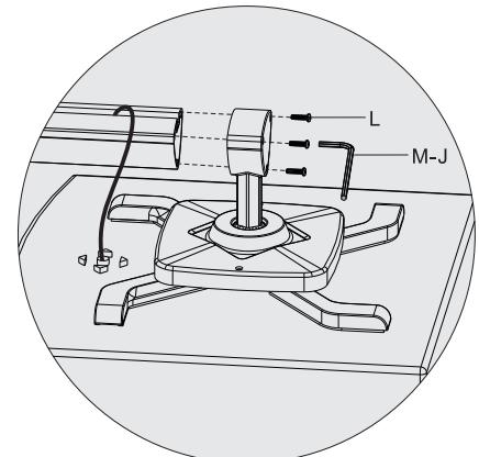
Закрепите пластину с проектором на штангу прилагаемыми винтами.
