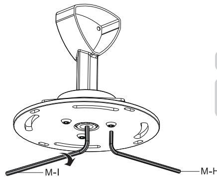
Затяните пластину проектора 6 мм ключом.
