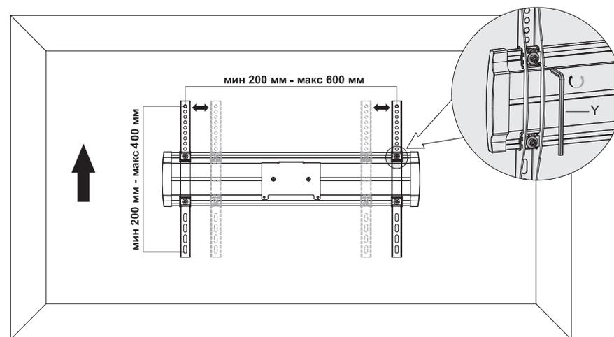
Отрегулировать адаптеры кронштейна так, чтобы отверстия в них совпали с отверстиями дисплея. Затем затянуть все болты торцовым ключом.
