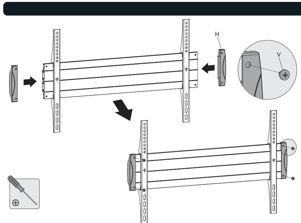
Закрепить две пластиковые крышки по краям держателя подходящими болтами. Закрутить все болты подходящей отверткой.
