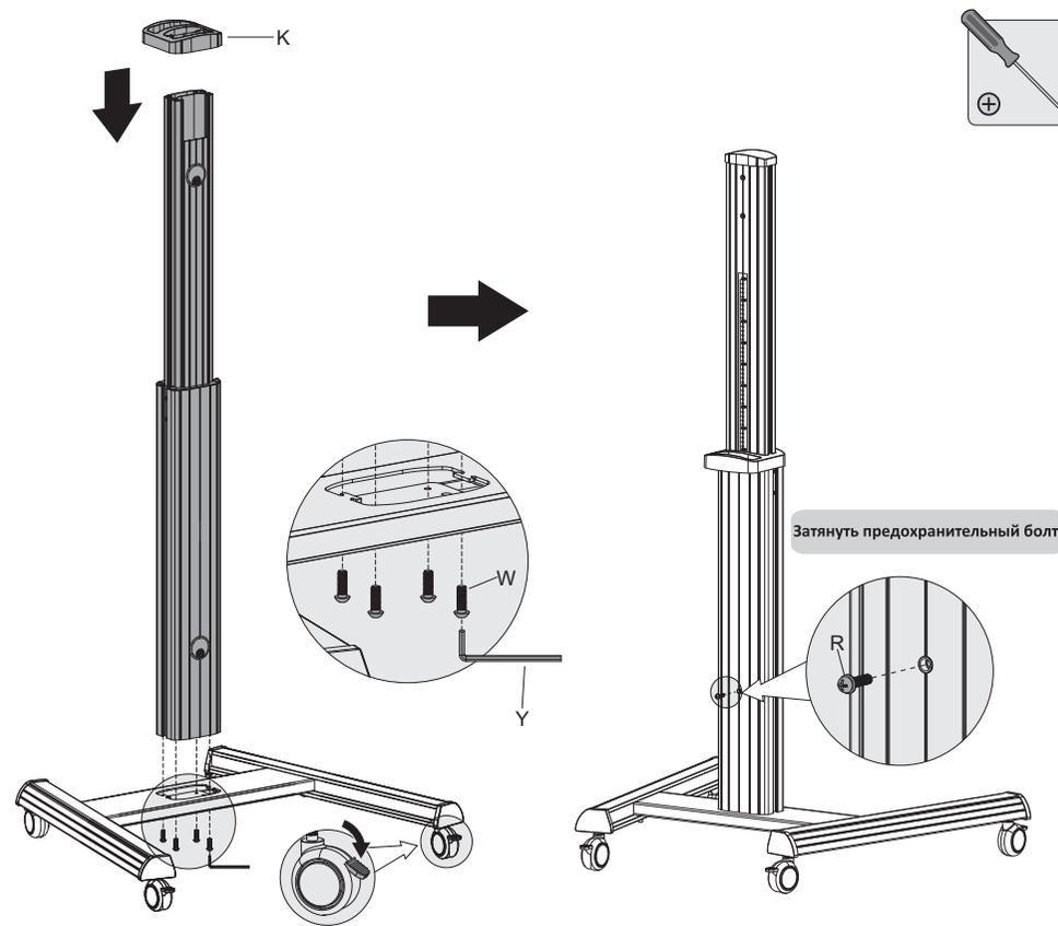
Прикрепить стойку к опоре болтами. Затянуть все болты торцовым ключом.
