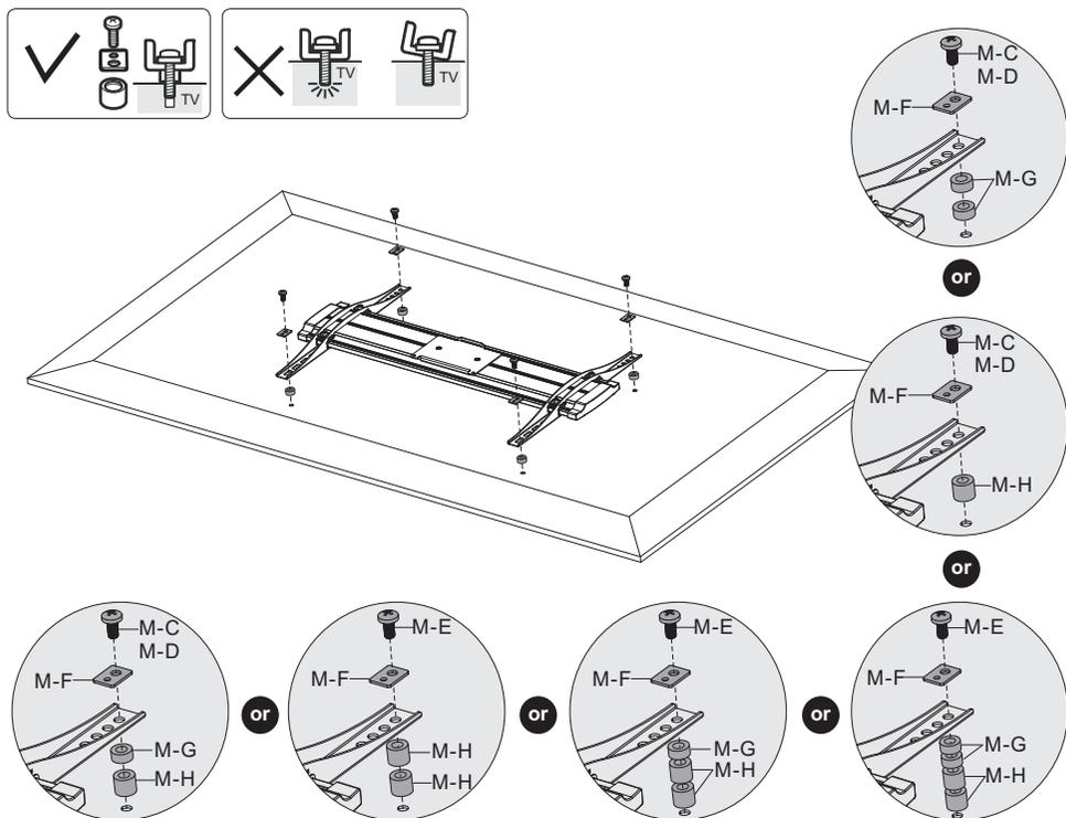
**Примечание:** выберите подходящие болты, шайбы и кольца (при необходимости) в зависимости от типа экрана. Адаптеры кронштейна болтами прикрепите к дисплею.
